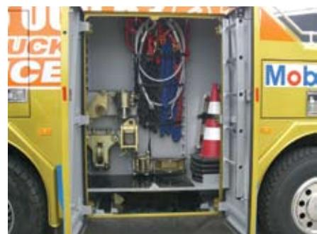
Pukseirvekil olemas autonoomne generaator 380V, 220V, 24V ja 12V väljastamiseks; kompressor kuni 200 l õhureserviga; mootori kävitamisvarustus ning transpordivahendite energiaga toitevarustus. Kahe vintsi (tõmbejõuga 20 ja 10 tonni) ning eri lisavarustuse abil suudame ümber aetud või väljaspool teed asuva sõiduki teisaldada või viia transpordiasendisse.
